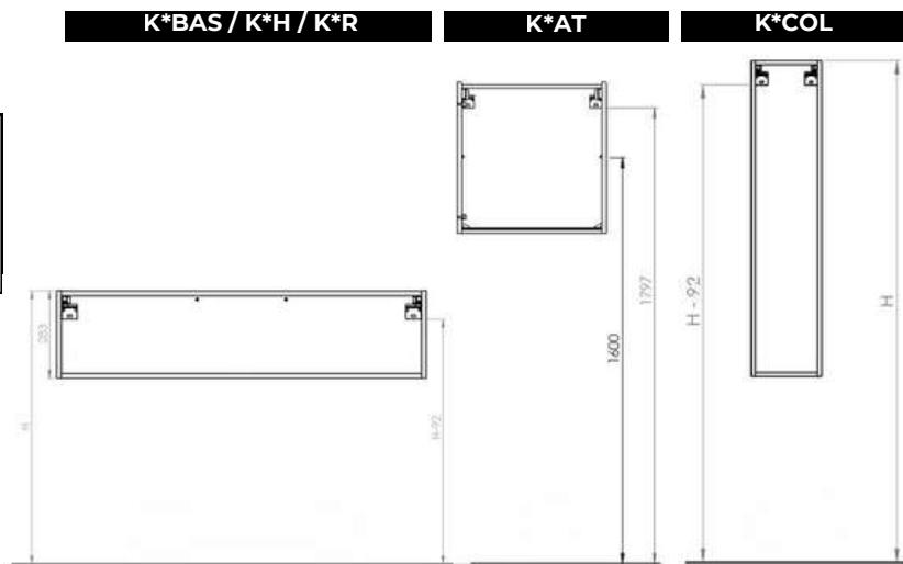
\*Pour les colonnes KMCOL de 60, 90 ou 120 cm de hauteur avec système d'ouverture par profil encastré, le calcul est : H - 160 mm.
